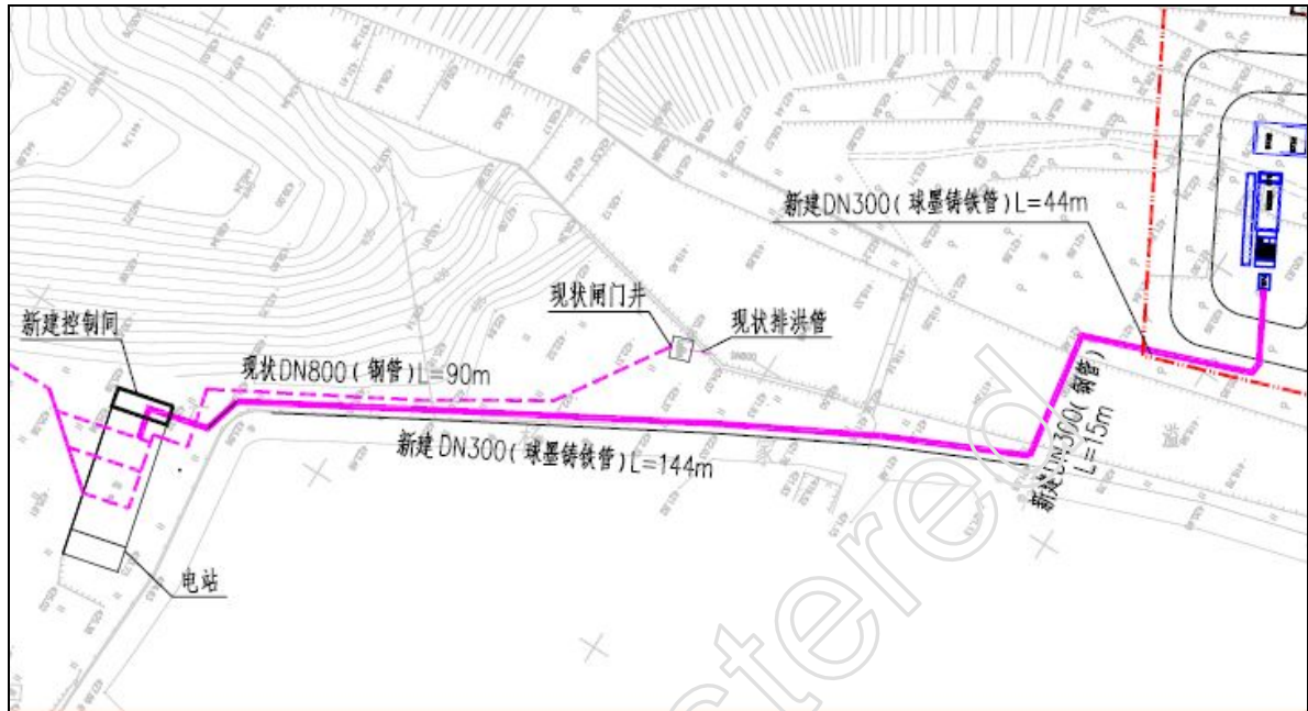
图 1 输水管线布置图
